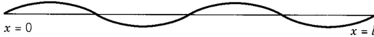
FIGURA 1. Cuerda vibrante unidimensional. La variable u = u(x, t) mide el desplazamiento sobre la vertical a tiempo t > 0 en la posición x \in [0, L] .
